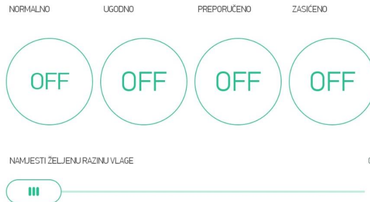
Slika 4. Tipke za odabir željenog načina rada i slider za namještanje željene razine vlage
